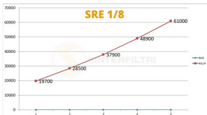
Prove di flusso / flow test
